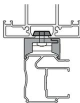
Druckplatte ohne Schienehalter für Montage an Murano-Glasdach
