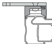
Distanzplatte für zweite Führungsschienseite bei Montage mit Seitenbefestigung / Montageverlängerung
